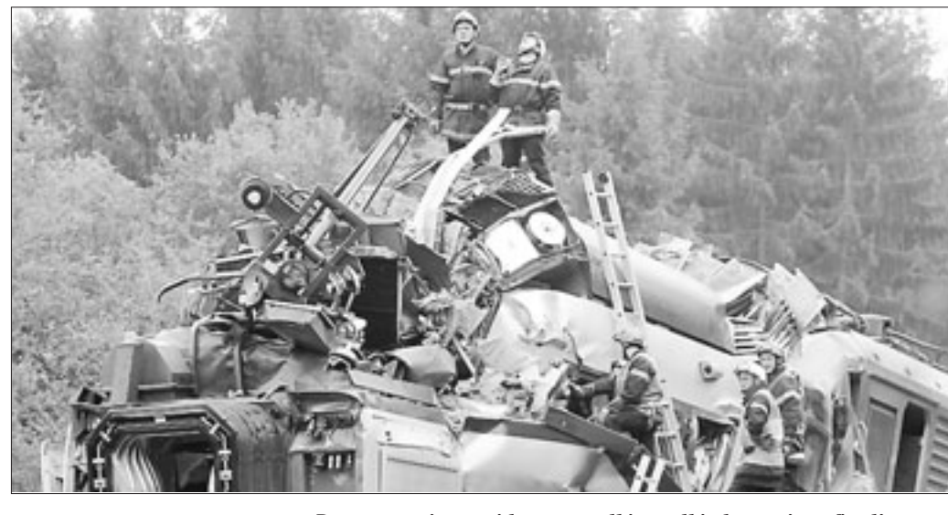
Deux pompiers guident par talkie-walkie le grutier afin d'amener les poulies au point d'ancrage des chaînes qui enserrant la motrice.
