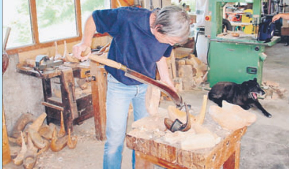
Pascal Jusot utilise encore des outils traditionnels, comme le paroir, pour sculpter les sabots
